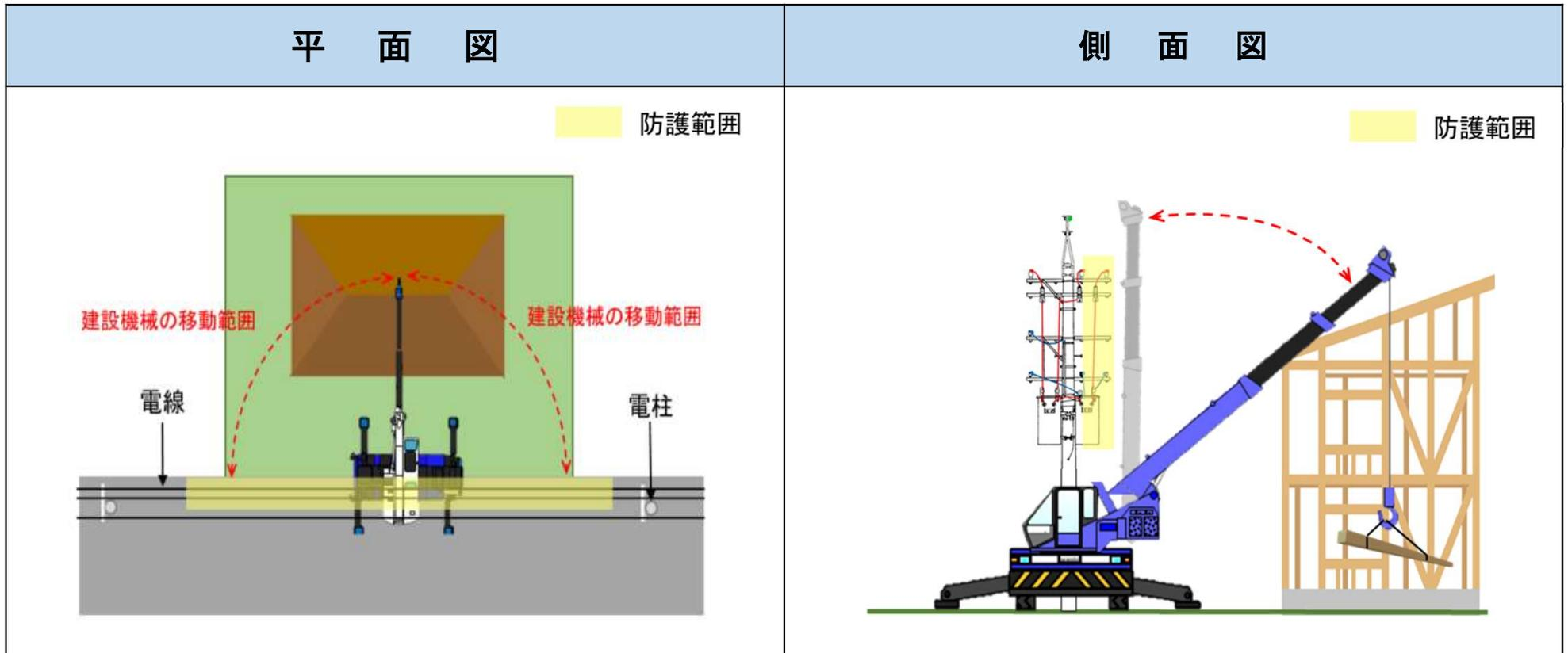
建設機械が下部から配電設備に接近する場合は、近接する配電設備に取付。建設機械の移動範囲と建設資材の大きさや揺れ幅等を考慮した取付範囲を決定。
